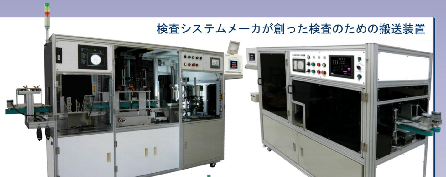
■ ボトル検査装置 (リーク検査付加)
